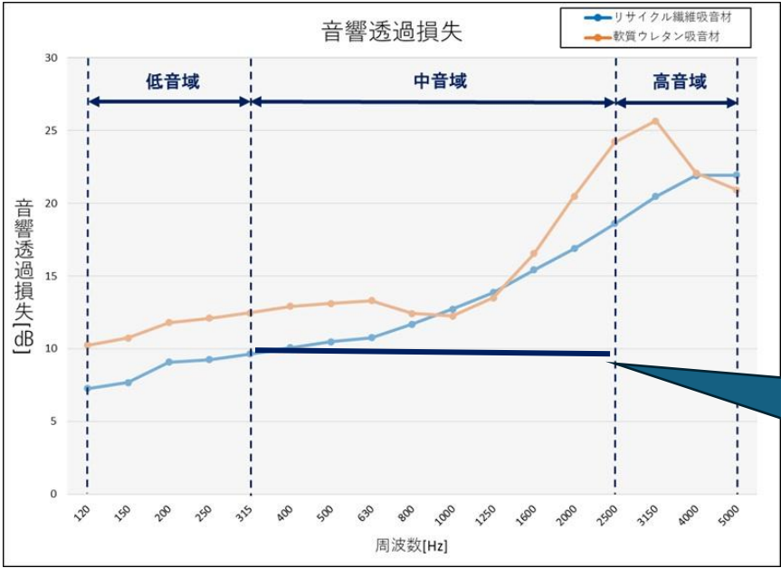
「音響管を用いた垂直入射音響透過損失測定 (ASTM E2611-09) 準拠」 測定方法：音響管を用いて材料に垂直に入射する音の透過損失を測定
