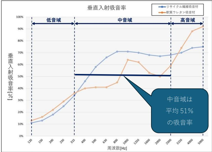
「音響管を用いた垂直入射吸音率測定 (JIS A 1405-2 準拠)」
