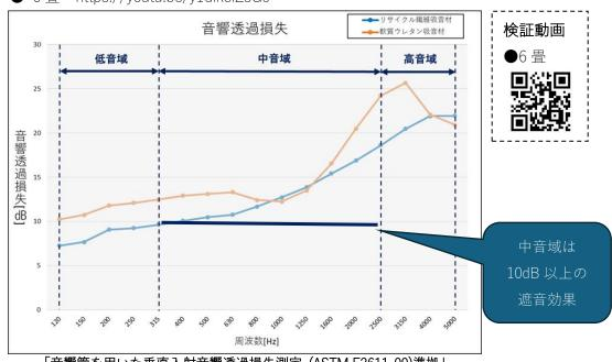
「音響管を用いた垂直入射音響透過損失測定 (ASTM E2611-09)準拠」 測定方法:音響管を用いて材料に垂直に入射する音の透過損失を測定
