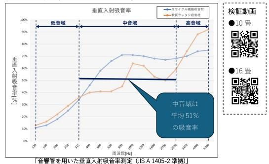
測定方法:音響管を用いて音が材料に垂直に入射する条件で吸音率を測定
