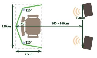
図のように、パネルをスピーカーと対面で向かい合わせ、椅子のすぐ後ろを囲うように設置します。その間に空間(リスニングスペース)を作り、スピーカーから発する音をパネルで受け止め、音の反響や反射を軽減します。旋律の中心となる中音域を中心に、吸音・遮音性能に優れたリサイクル繊維吸音材(※P3素材性能試験データ参照)を、成人男性が椅子に腰かけた際、頭部(耳)位置となる上部に使用しています。
