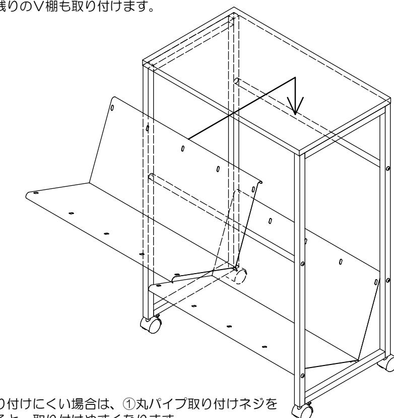
※ V棚が取り付けにくい場合は、①丸パイプ取り付けネジを少し緩めると、取り付けやすくなります。
