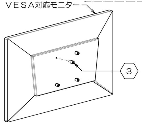
※付属のネジ(③スペーサーネジ)が最後まで締まらない、また少ししか回っていない等、ネジが合わない場合は、強度に十分ご注意の上、市販の適切なサイズのネジをご用意下さい。(図B参照)
