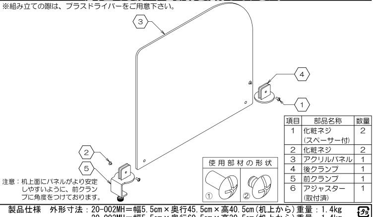
外形寸法: 20-002MH=幅5.5cm×奥行45.5cm×高40.5cm(机上から)重量: 1.4kg
