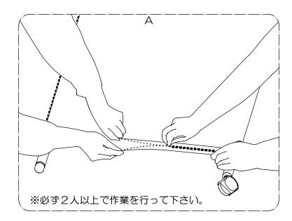
注)製品の構造上、⑦張り布のテンションはとてもきつく設計されています。 1人で作業を行うと、ファスナーを破損したり布を破く恐れがあります。 必ず2人以上で作業を行って下さい。
