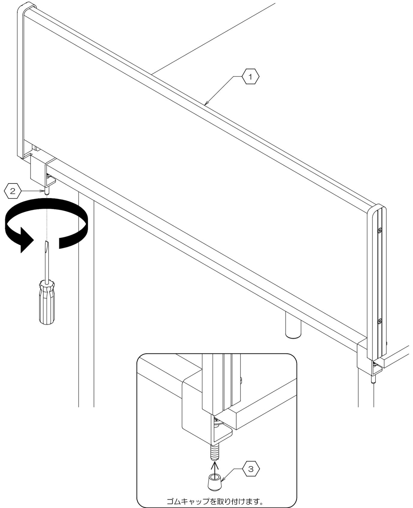
製品仕様 外形寸法：YSP-100＝幅 980mm × 奥行61mm × 高405mm 重量：4.5kg(布タイプ4.7kg)
