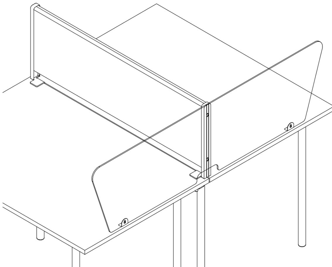
製品仕様 外形寸法：幅1295mm×奥行23mm×高352mm
