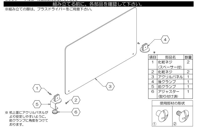
外形寸法:幅55mm×奥行608mm×高403mm クランプ含む (机上から355mm)
