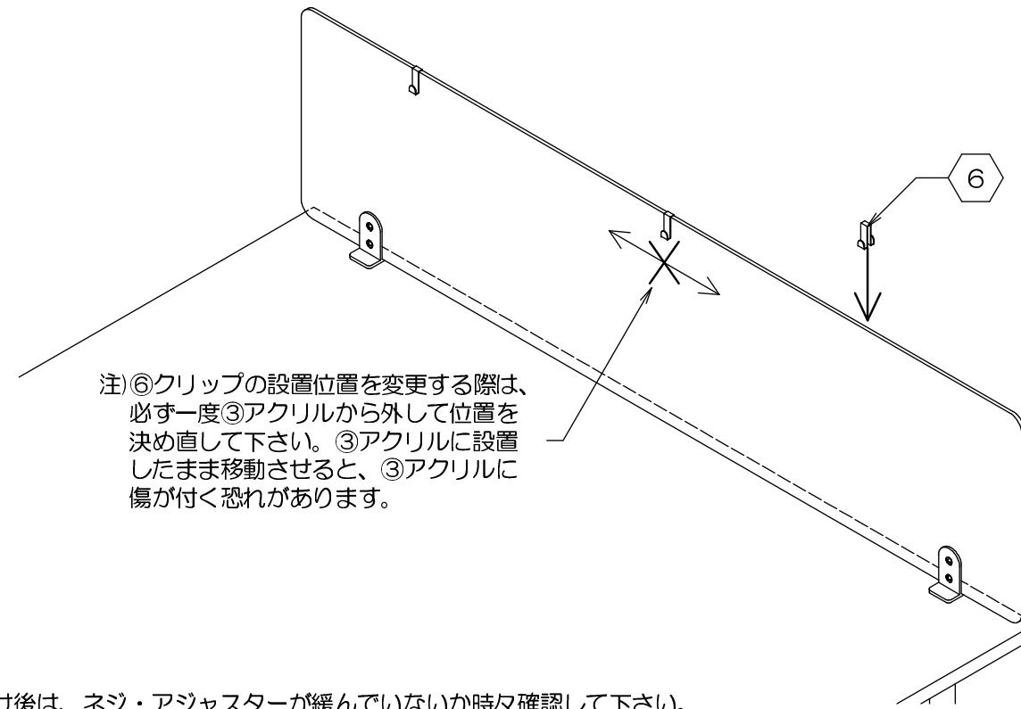
注)⑥クリップの設置位置を変更する際は、必ず一度③アクリルから外して位置を決め直して下さい。③アクリルに設置したまま移動させると、③アクリルに傷が付く恐れがあります。
