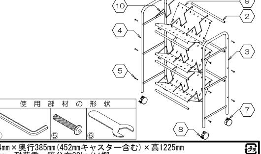
外形寸法:幅574mm×奥行385mm(452mmキャスター含む)×高1225mm
